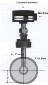
VORTEX FLOW METER
